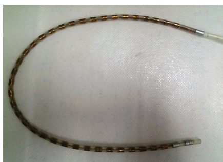
注:导管外径为 4.2 mm,含有 36 个间隔 1 cm 的圆周传感器,每个传感器含有 12 个环绕压力感应点
