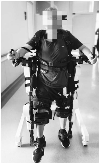
图 1 下肢外骨骼机器人步行训练
