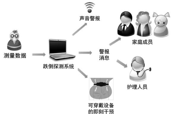
图 5 防跌倒探测系统
